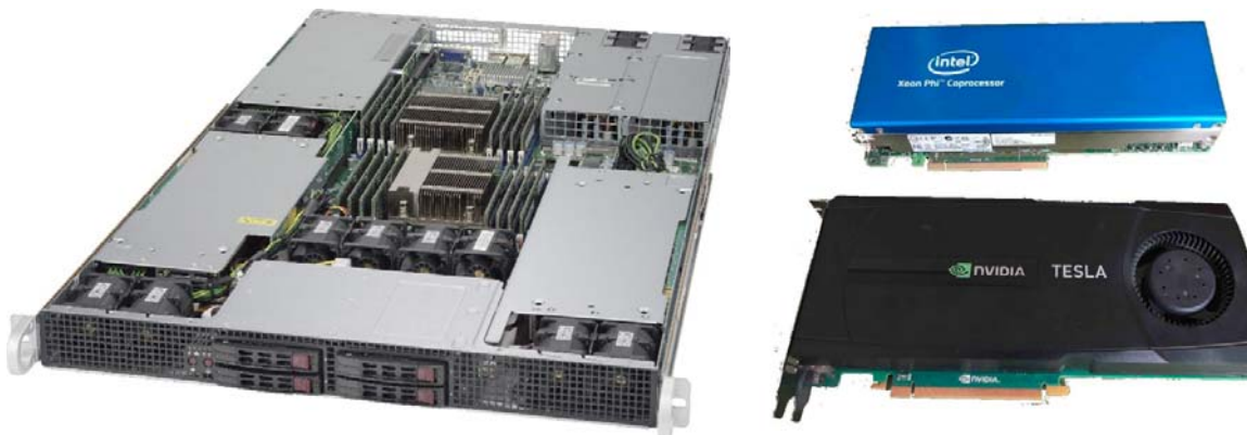
Obr. 5 Výpočetní server vhodný pro provoz on-line modelů a Intel Xeon Phi, GPU karta nVidia
